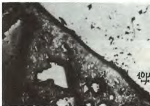
Fig. 8 Interface pâte de ciment/agrégat. Mortier (conditions normales)
