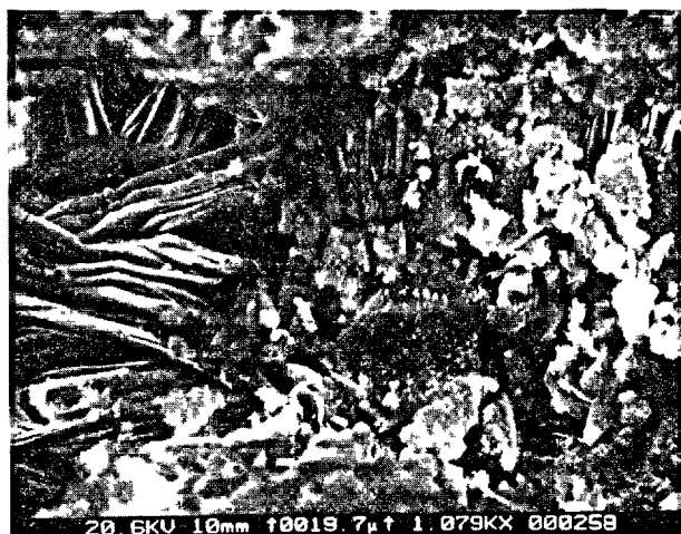
Cliché 3 - CA ( 40 < \phi < 75 \mu ) Produit hydraté 13 h à 25°C Grossissement 1080
