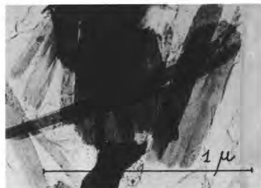
Fig. 12 Tobermorite. Mortier traité en autoclave
