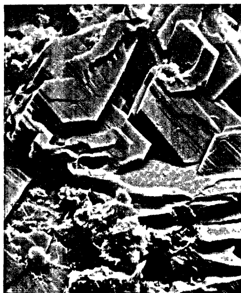
FIGURE 5 : "Surface de rupture côté zinc - Cristaux obtenus à 15 Jours" -(x 1500)-
