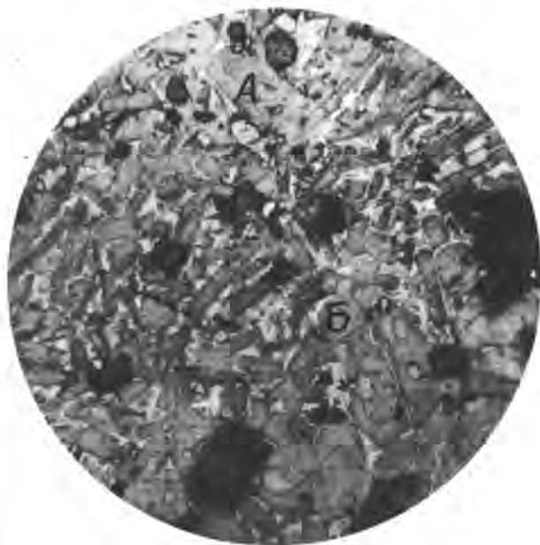
Fig.2. Microstructure des mâchefer granu- lés à alite (A-alite, B-bélite, lumière réflectie, X200)
