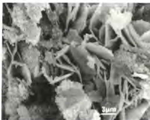
Fig. 9 : Pâte C3S + C3A + gypse, 7 jours, monosulfoaluminates.
