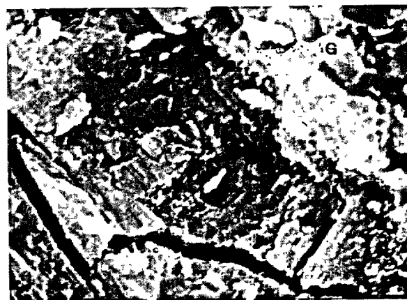
FIGURE 7 : Echéance 90 jours - (a) Granulats polis, (b) Granulats concassés, G = Granulat, P = Pâte 5 \mu\text{m}
