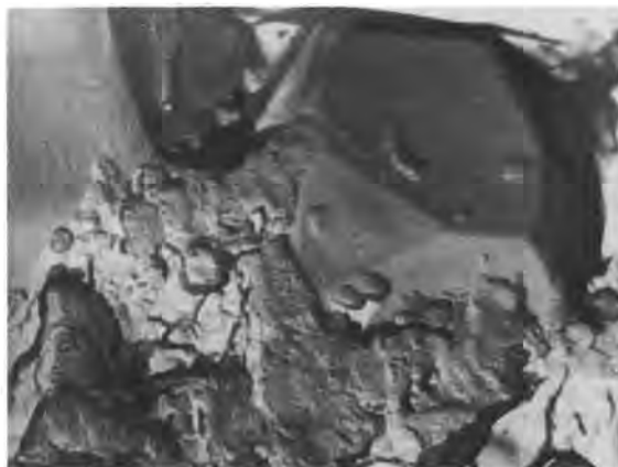
Fig. 7. Variétés du faciès des cristaux de l'alynite dans le clinker; a - photos des répliques des clivages des grains de clinker prises au microscope électronique ME - 5, agrandissement de 4000, b - stéréomicrophotographies prises au microscope électronique à balayage, agrandissement de 2800.
