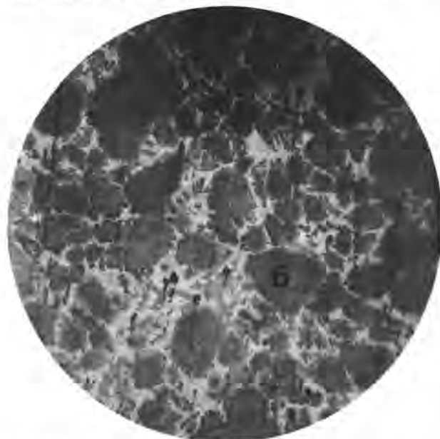
Fig.1. Microstructure des mâchefers granulés schistocendreaux (B-bélite, lumière réfléchie, X200)
