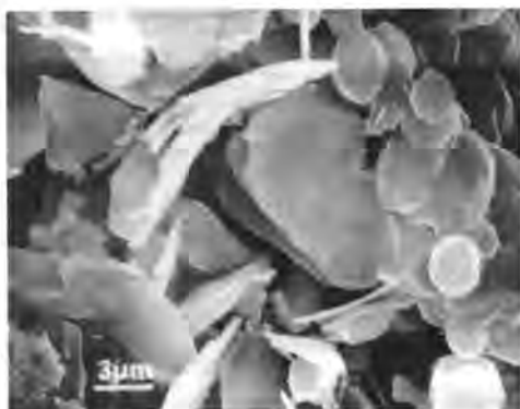
Fig. 1 : C3A hydraté 2 jours. Dodécaèdres rhomboïdaux de C3AH6 et plaquettes de C4AH13.
