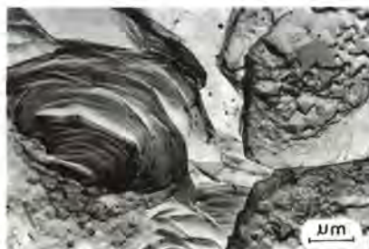
Fig. 4 - Pâte de C_3A + Na_2S_2O_3 durcie 24 heures. Agglomérat de plaquettes hexagonales fortement déformées
