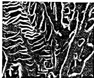
Fig. 5 (MEB) : Cristallisation dendritique de la merwinite (M) dans le laitier vitreux (V) n° 2 (section polie attaquée par NH_4Cl ).
